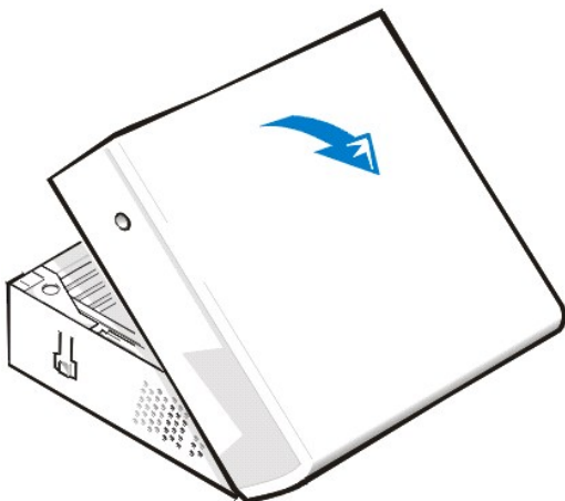
Рис. 2. Снятие крышки компьютера (плоское шасси)
