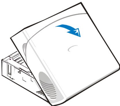
Рис. 2. Снятие крышки компьютера (плоское шасси)
